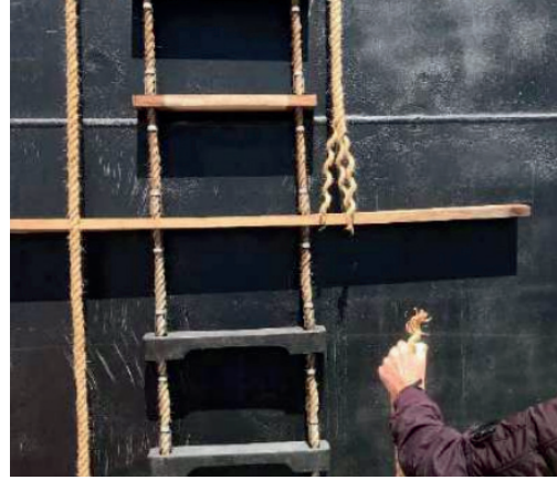
Filasalanmış ve kopmuş halat
