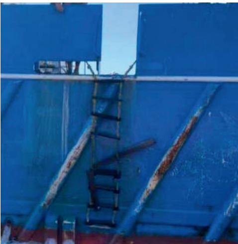
Yoğun kullanım sonrası aşınmış kırılmış basamak
