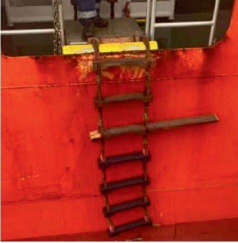
Çarmıhın kötü deniz koşullarına maruz kalması akabinde kırılan basamak
