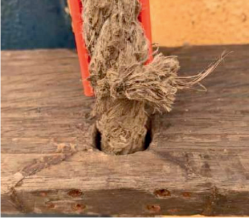
Filasalanmış ve yıpranmış halat
