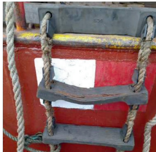
Yoğun kullanım sonrası aşınmış ve kırılmanın eşiğinde olan basamak
